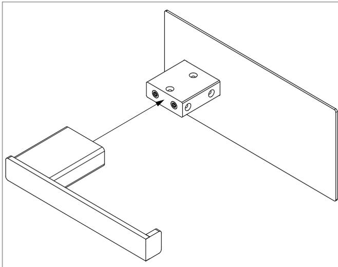
5. Fixer l'axe du porte-rouleau au support à l'aide de vis M4X10.
