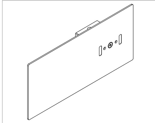
3. Placer le support sur le mur et le fixer à l'aide de vis et de chevilles adaptées au mur utilisé.
